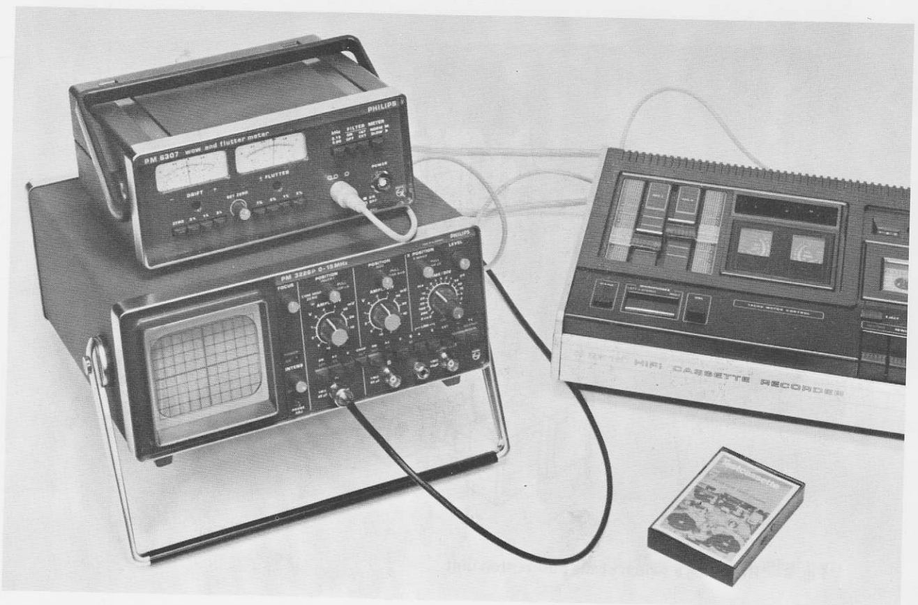
Fig. 6 Wow and flutter measurements of a cassette recorder Gleichlaufmessung an einem Cassetten-Recorder Mesure de wow et flutter d'un enregistreur sur cassettes
