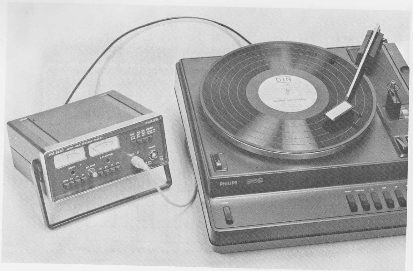
Fig. 5 Wow and flutter measurements of a record player Gleichlaufmessung an einem Plattenspieler Mesure de wow et flutter d'un tourne-disques
